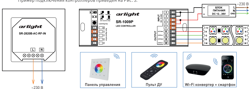
Рис. 3. Схема подключения оборудования на примере контроллера SR-1009P.
