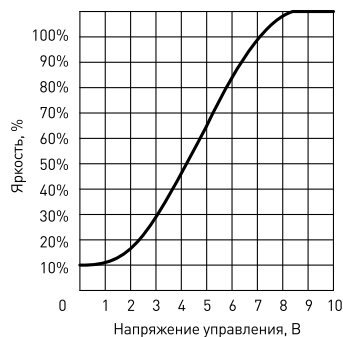
Яркость от напряжения управления (100%-нагрузка)
