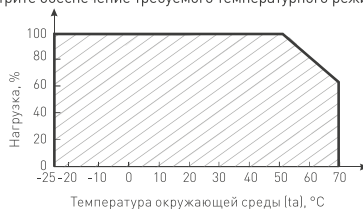
Рис. 3. Максимальная допустимая нагрузка, % от мощности источника
