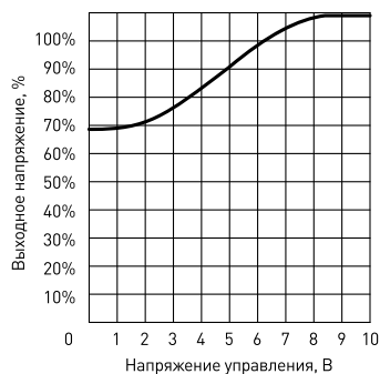
Изменение выходного напряжения от напряжения управления
