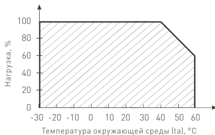
Рис. 2. Максимальная допустимая нагрузка, % от мощности источника.
