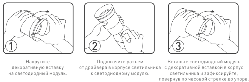
Рис. 2. Сборка светильника
