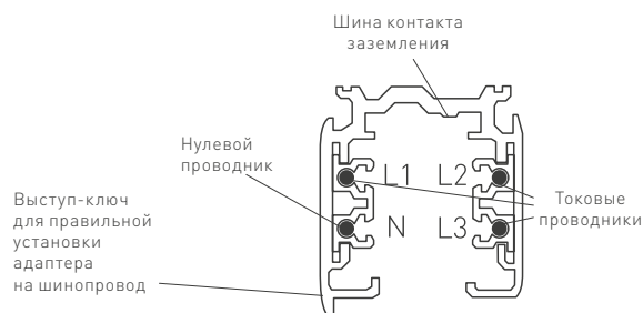
Рисунок 1. Конструкция шинопровода
