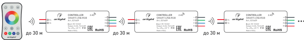
Рисунок 2. Ретрансляция сигнала от пульта ДУ (до 30 м на открытом пространстве)
